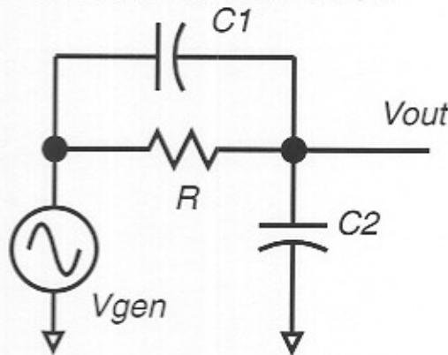
$$R=1 \text{ KOhm} \quad C_1=1 \text{ fF} \quad C_2=0.5 \text{ fF}$$
